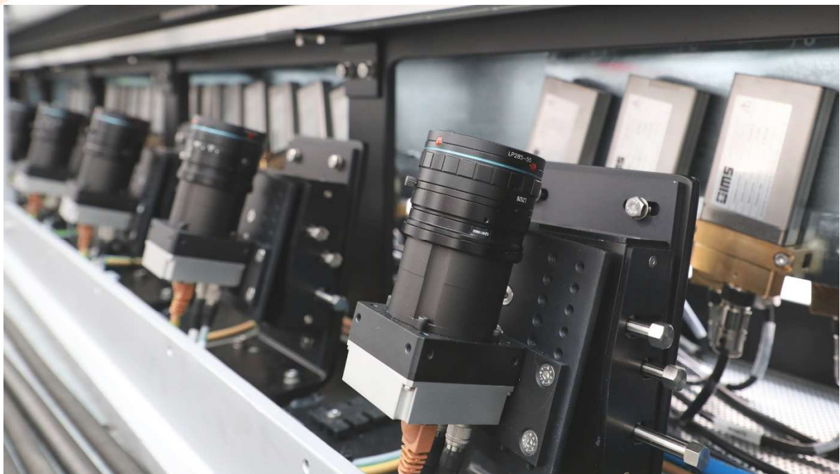
Foto 1: ispezione online al 100% con telecamere a scansione lineare veloce e LED ad alta potenza 1
